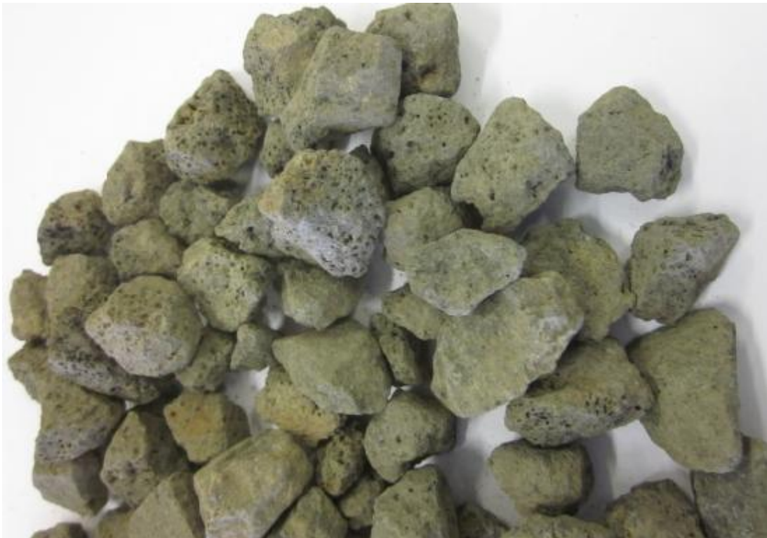
Mynd 8 Fylliefni úr Sandskarðsnámu, 8/16mm korn.
